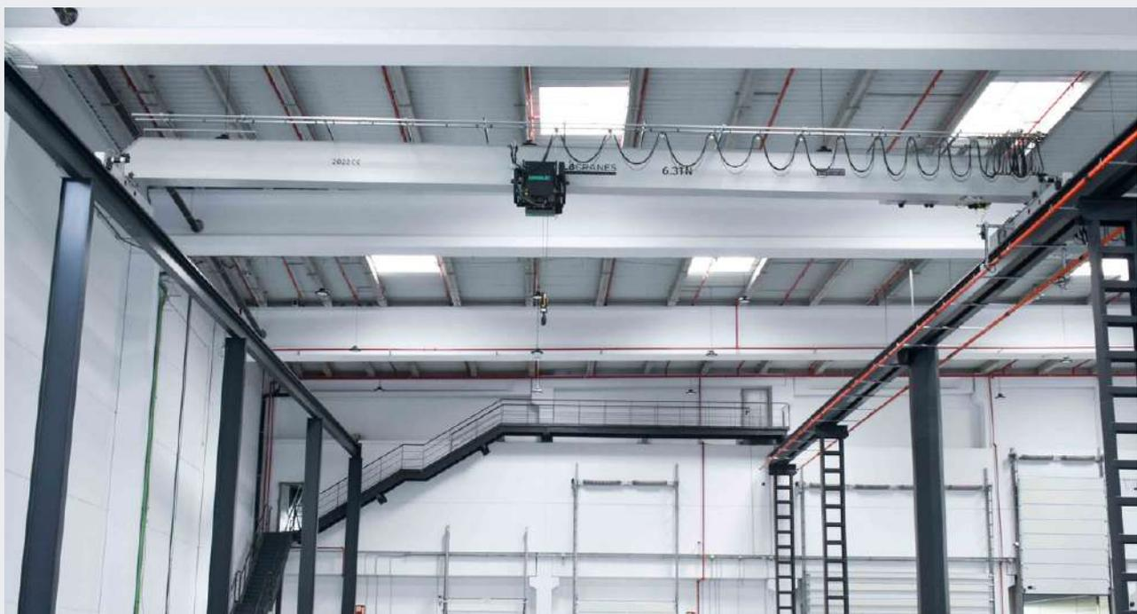
Palan à câble de 6,3 tonnes dans un pont roulant monopoutre.
